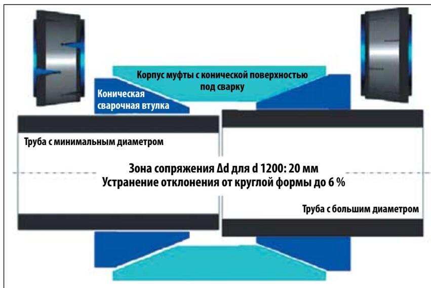
Рис. 7. Возможность сборки труб с разным фактическим диаметром.
